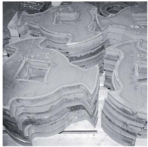
branden van breektanden in speciaal staal
