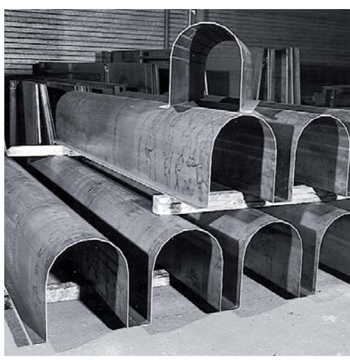
plooien van symmetrische transportgoten (lengte 30 m)
