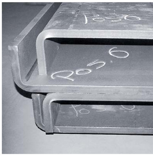
plaatdiktes tot 25 mm met hoge nauwkeurigheid
