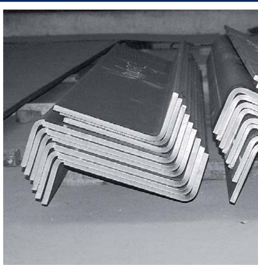
plaatdiktes tot 25 mm met hoge nauwkeurigheid
