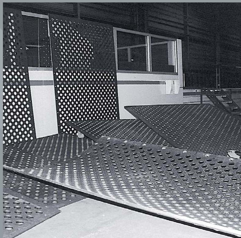
tôles découpées au laser en acier anti-abrasion (500 HB)
