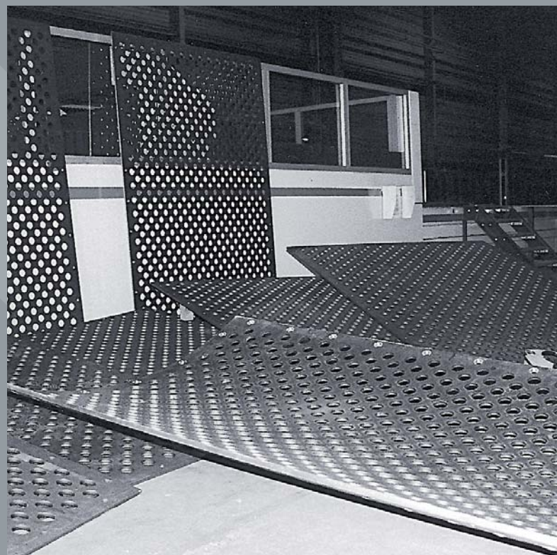
geperforeerde platen in slijtvast staal (500 HB) dikte 12mm met \pm 800 gaten \varnothing 24 mm en gerold \varnothing 2450 mm
