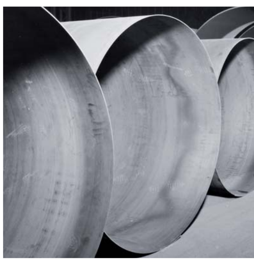
cilinders dia. 2100 mm hoogte 2500 & dikte 15 mm
