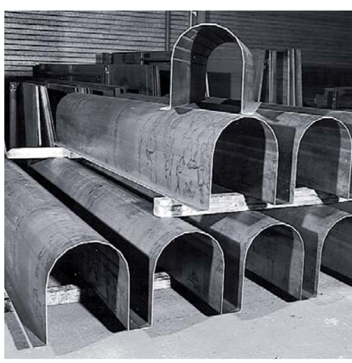
plooien van symmetrische transportgoten (lengte 30 m)
